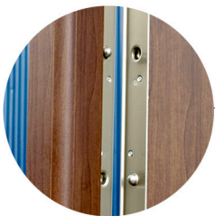
Cerco triple cámara, de aluminio, espesor 2 mm, grueso 120 mm.
